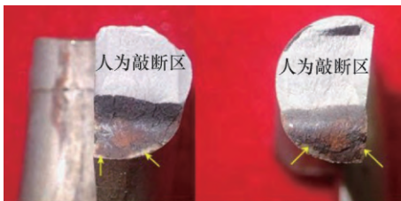
b) 裂纹2敲开后断口形貌
