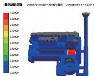
图10 浇注系统工艺方案一缺陷位置
