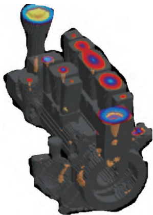
图14 供油系统方案一缺陷CT分布
