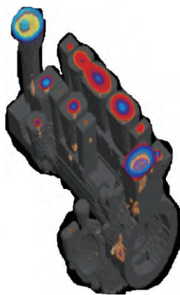
图15 供油系统方案二缺陷CT分布
