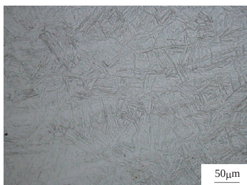
a) 固溶水淬试样
