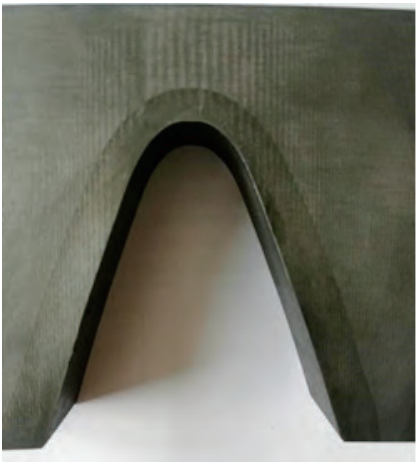
图3 齿部切样宏观形貌
