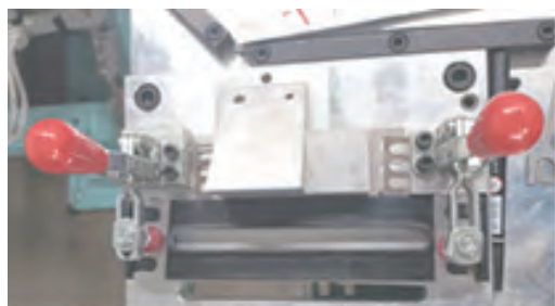
图4 激光焊接专用试焊平台
