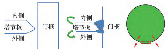
图7 门框与塔节板K形坡口
