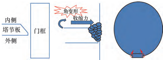
图6 门框与塔节板单V形坡口
