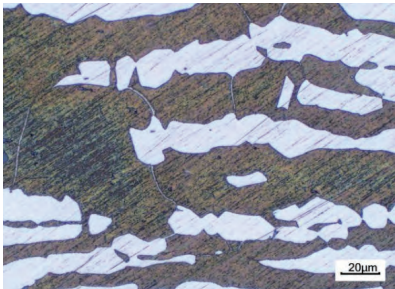
图5 左侧热影响区（根部）区域的显微组织
