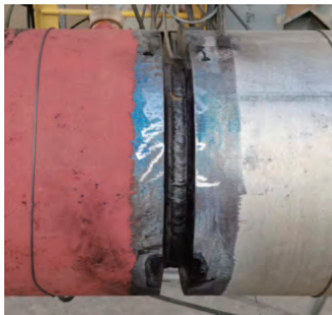
图5 焊接 12\sim 15\text{mm} 后准备第一次射线检测
