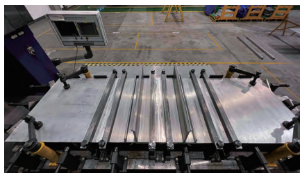
b) 优化后牵引梁组焊工装实物
