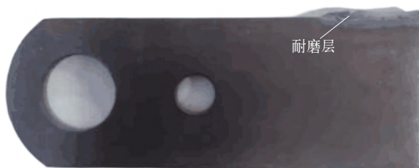
图2 机械刀具耐磨层实物
