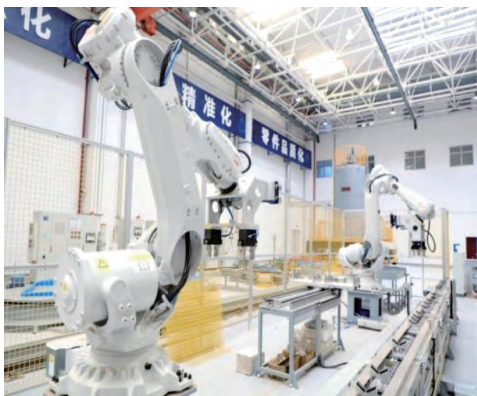
图2 管材自动打磨、硬度检测及校直系统
