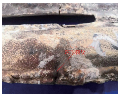
图4 管道裂纹处宏观形貌
