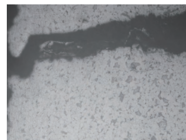
b) 裂纹末端 (管道内侧)
