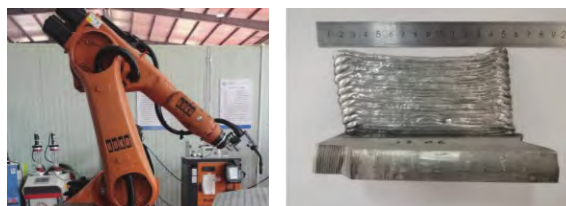
a) CMT电弧增材制造设备 b) 试验材料宏观形貌
