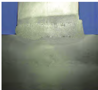
图8 宏观酸蚀金相检测照片
