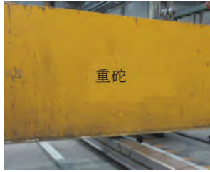
图10 底架边梁调修示意
