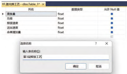
写入列名：离焦量、功率、焊接速度、送丝速度及余高增加量。数据类型写为float。点击“保存”按钮，输入表名，第3层焊接工艺，如图8所示。
