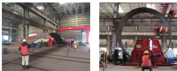
a) 来料后进行材料验收以及放样划线 b) 切割后卷制
