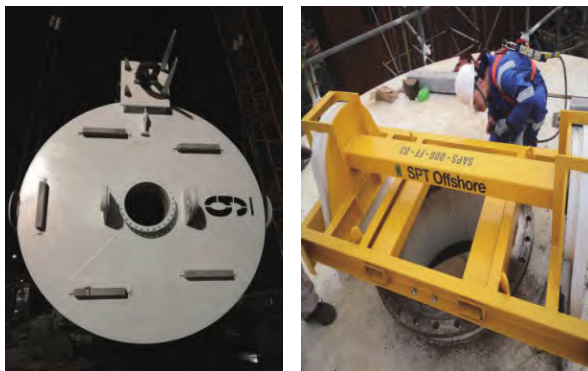
a) 顶部板式吊点 b) 泵机组模型工装装配测试
