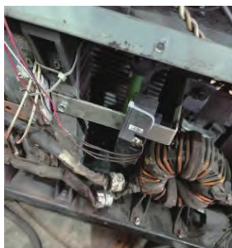
图5 尺寸合适的传感器安装方式
