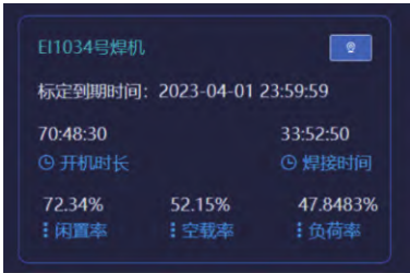
图12 焊机超标定日期作业预警测试
