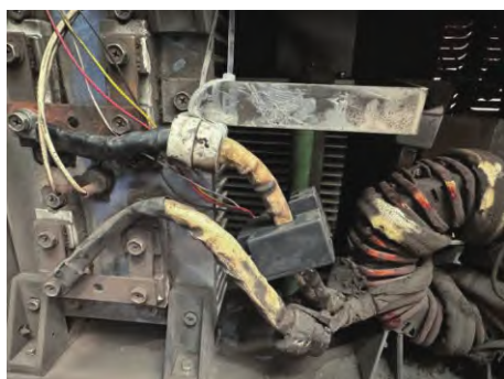
图6 尺寸不合适的传感器安装方式
