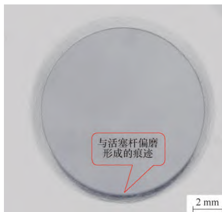
图6 故障外加螺母偏磨位置
