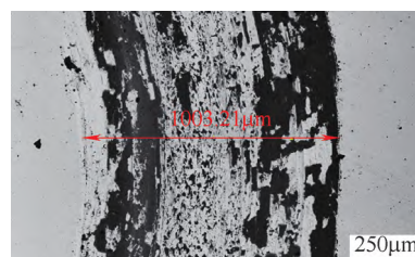
b) 施加超声振动的磨损试样磨痕宽度（振幅60 \mu\text{m} ）
