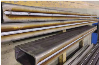
图3 焊后的天线骨架梁
