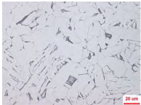
d) 对比件焊缝显微组织
