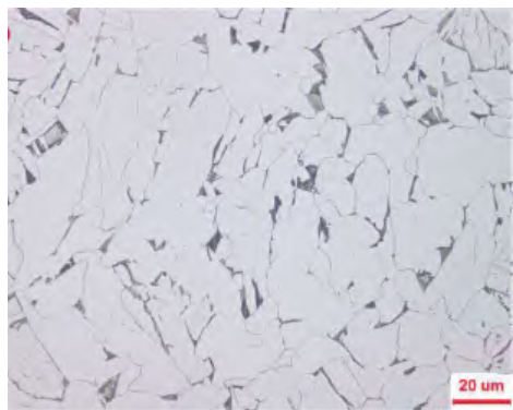
b) 失效件焊缝显微组织
