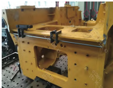
图9 后罩安装座组对空间样板现场应用
