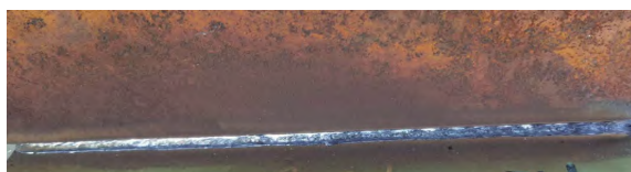
a) V形坡口横焊、平焊
