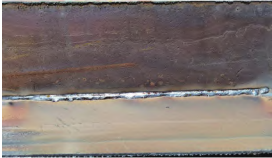
a) V形坡口横焊
