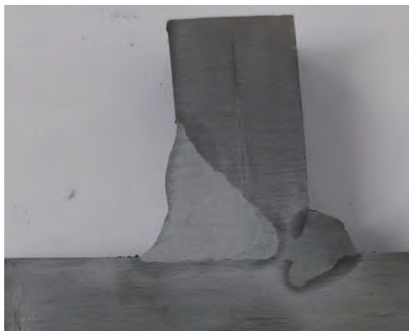
a) V形坡口横焊
