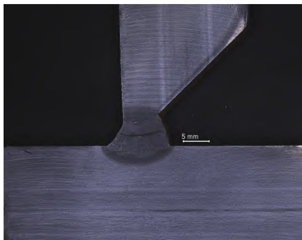
a) V形坡口横焊、平焊
