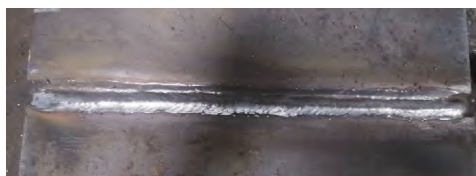
图4 80%Ar + 20%CO 2 保护气体焊接成形
