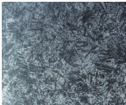
图1 P20钢经850℃加热淬火后的金相组织(500×)
