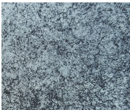
图2 P20钢经850℃加热淬火、620℃回火后的金相组织 (500×)
