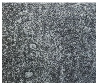
图6 5NiSCa钢经880℃加热、油淬、600℃回火后的金相组织 (500×)
