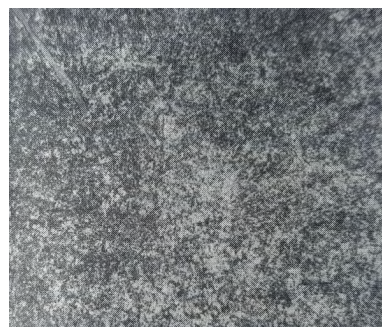
图4 8Cr2S钢经900℃加热淬火、600℃回火后的金相组织 (500×)
