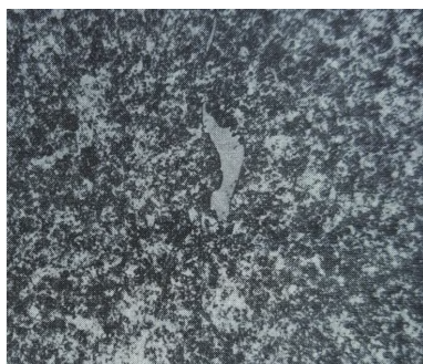
图3 8Cr2S钢经900℃加热淬火后的金相组织 (500×)
