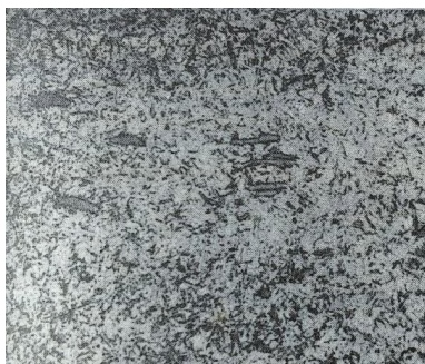
图5 5NiSCa钢经880℃加热淬火后的金相组织 (500×)
