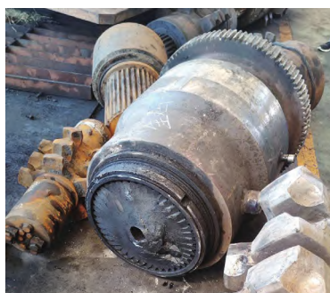
图2 40CrNiMo钢链轮轴断裂形貌
