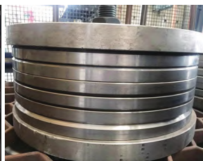
图5 防变形淬火后环形 零件实物
