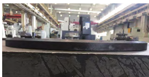
图6 淬火后零件变形状态
