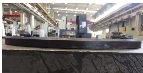
图6 淬火后零件变形状态
