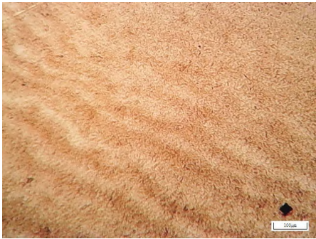
图5 1#样件表层马氏体6~7级,组织明暗纹严重(100×)
