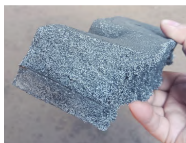
图7 齿轮箱浇口附近粘砂
