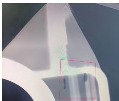
图4 齿轮箱射线检测吊挂区域气孔
