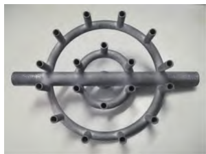
图3 验证型号喷嘴组件3D打印件
