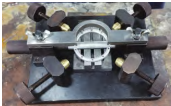
图4 喷管组件焊接定位夹具
