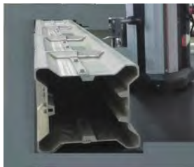
图6 箱体焊接变形量检测
