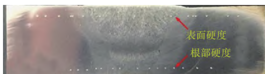
图9 焊接接头硬度测试
