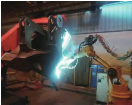
图11 工程机械产品结构件现场焊接
