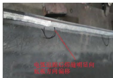
b) 焊缝向底板方向偏移
