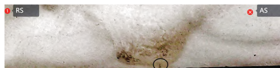
a) 转速1200r/min、焊接速度800mm/min
