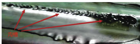
c) 转速1800r/min、焊接速度300mm/min
