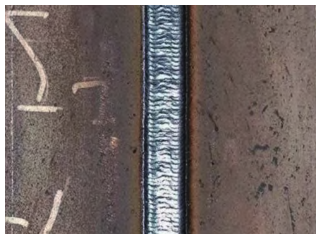
图6 液压缸MAG窄间隙焊缝成形
