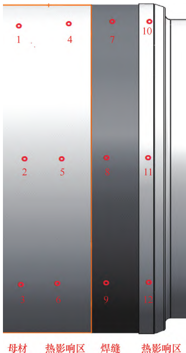
图4 液压缸MAG窄间隙焊接接头硬度检测位置
