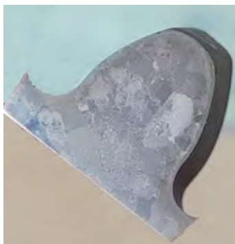
图1 轮齿试样腐蚀面
