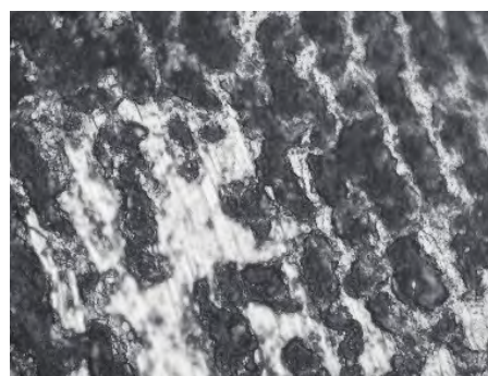
图5 1100°C无涂层氧化铁皮断面形貌
