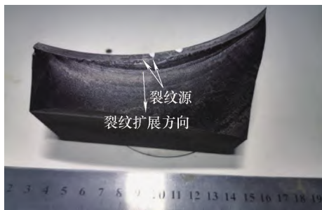
图8 裂纹2 疲劳贝壳线
