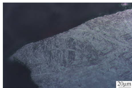
图4 裂纹源处金相组织 (马氏体, 500×)
