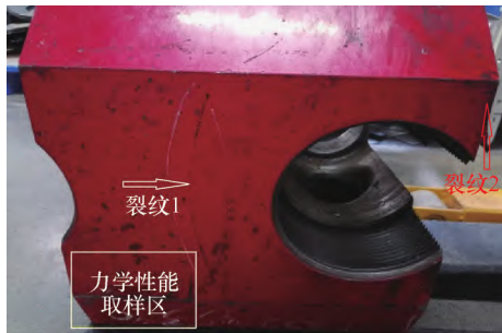
a) 泵头体裂纹位置
