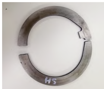
图1 断裂失效止推垫片宏观形貌
