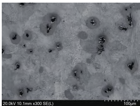
c) 含水率6%时-25℃冷冻砂型
