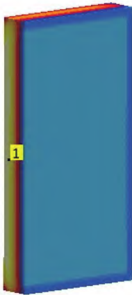
图2 试块热节模数的选取位置
