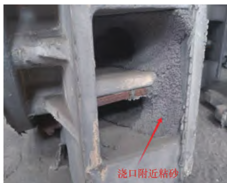
b) 吊挂内浇口附近粘砂
