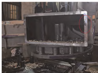
图8 顶部气孔缺陷
