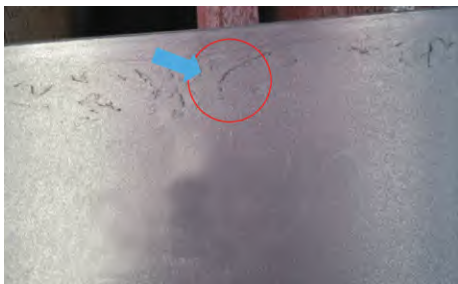
图5 薄板表面龟裂
