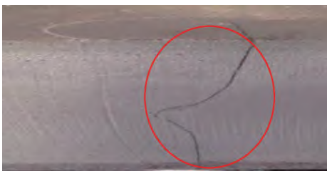
图18 边部开裂缺陷
