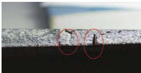
图8 轧制后的边部裂纹
