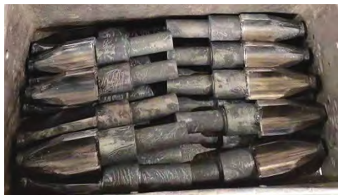
图3 冷挤压后的螺杆头实物表面状态
