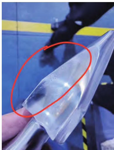
图2 挤压试验后螺杆头凹槽处表面缺陷
