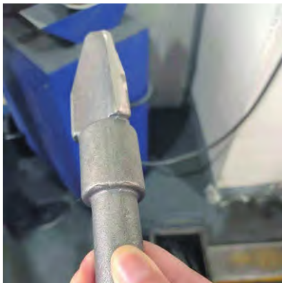
图1 模锻后螺杆头实物
