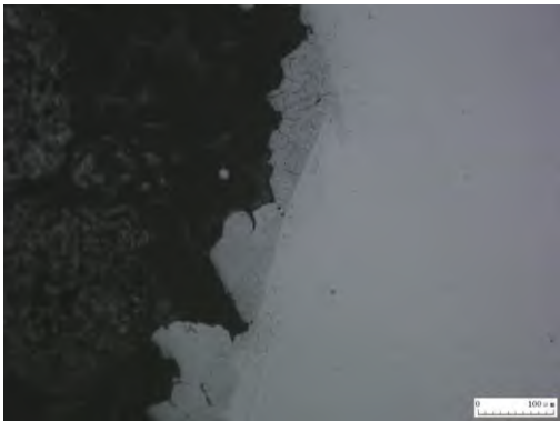
图4 持久试样断裂侧金相组织
