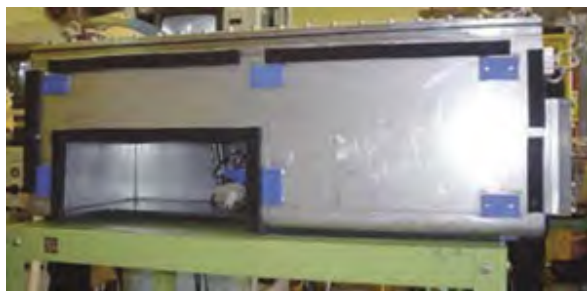
图2 日本水下角焊缝气室 [3]
