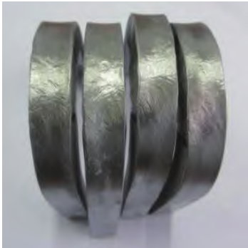
b) 进口焊丝横向侧弯试样
