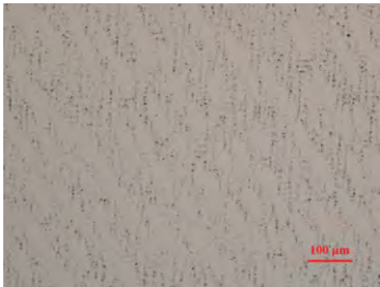
a) 国产焊丝焊缝微观组织
