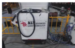
图1 ALT-LC-NP-1000型激光清洗器
