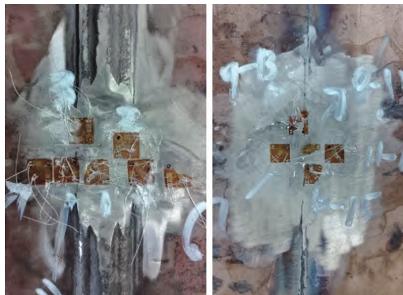
a) 焊板上表面焊接接头应力测点试验
